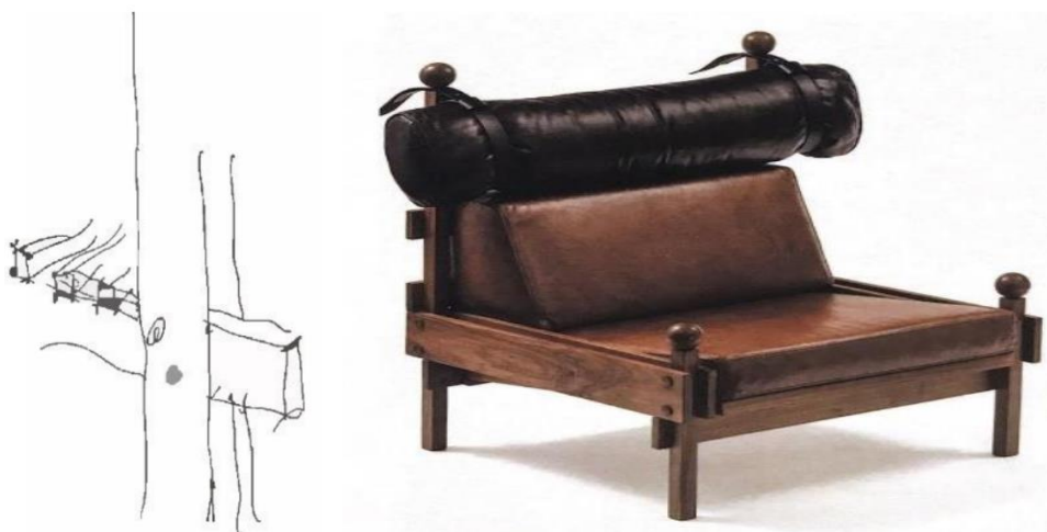
Figura 374 e 375: Croqui de Sérgio Rodrigues, explicando a justaposição das peças (374); e a Poltrona Tônico (1965), com mesmo esquema de aparafusamento (375). Fonte: RODRIGUES apud. OGAWA, 2021 (374); VACCARO apud OGAWA, 2021 (375).
