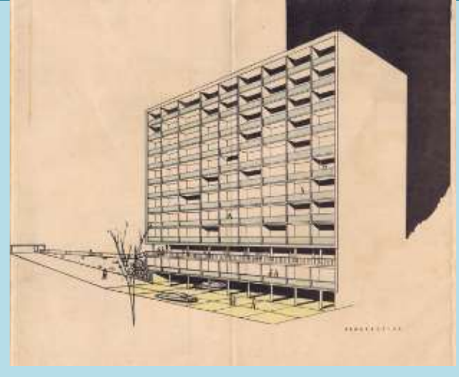
Figura 2.6- Edifício Bela Vista (1957) – projeto do Escritório Berbert & Peixoto- atende ao uso de pilotis e garagem coberta. Rua Gonçalves Dias 8 (antiga Bela Vista do Cabral)-Nazaré, Salvador 11
