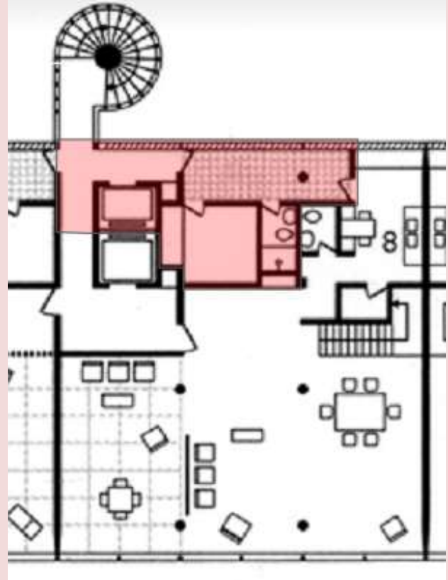
Figura 3.60- Apartamento tipo edif. Nova Cintra (1948) - Parque Guinle com destaque para a área de dependências segregadas.
