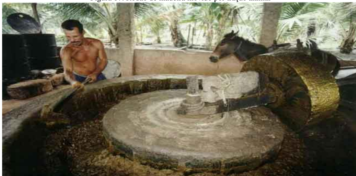
Figura 07: Rodão de madeira movido por tração animal
