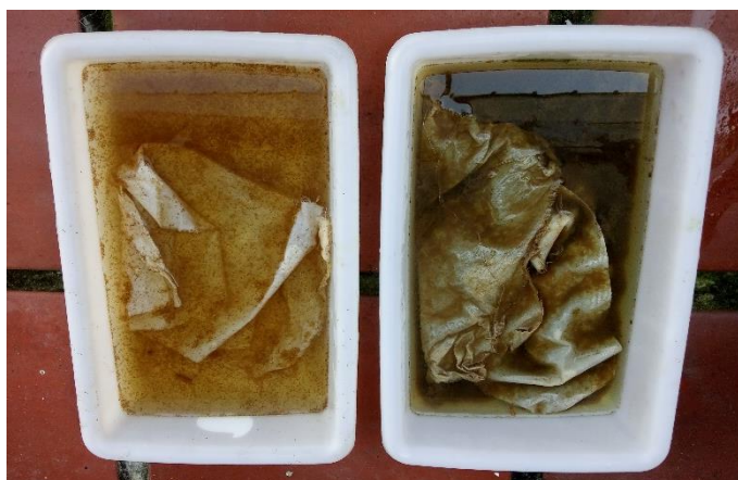
Figura 46 - Desintegração de partículas do dendê ao ser tingido com ferro e alúmen de potássio
