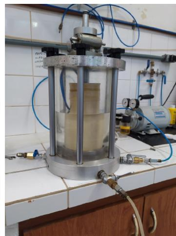
(c) Corpo de prova na câmara
