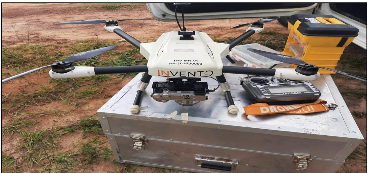
FIGURA 121 - DRONE MULTIROTOR MODELO QUANTUM SPIDER 700 EM OPERAÇÃO DE CAMPO. FOTO 2022.
