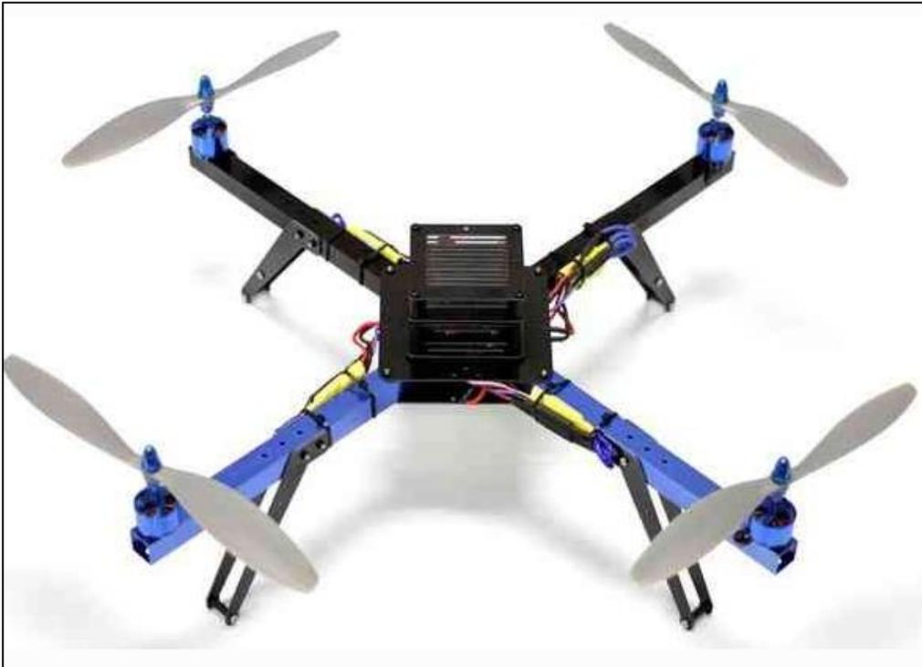
Figura 119 - Drone do Tipo Multirotor modelo quadcopter (4 motores).
