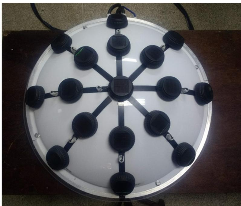
**Figura 3.6** - Vista superior do detector de topologia *fly eye*.
