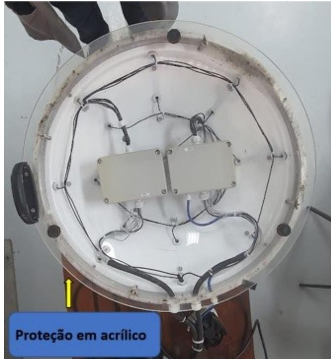
**Figura 3.11** - Acrílico de proteção.
