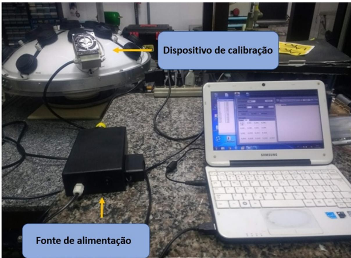
**Figura 3.15** - Sistema de calibração dos sensores.
