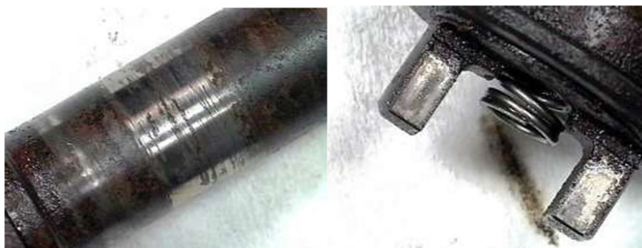
Figura 2.2 Desgaste provocado pela corrosão e ferrugem, devido a presença de água. Fonte: (AEA, 2019)
