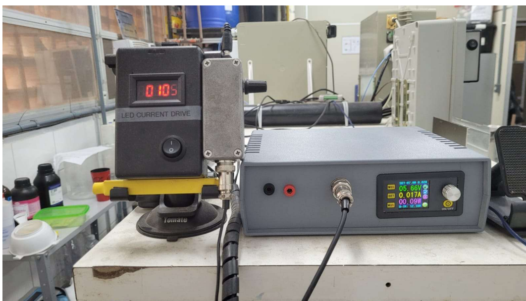
Figura 3.13 Foto das fontes de corrente em detalhes.
