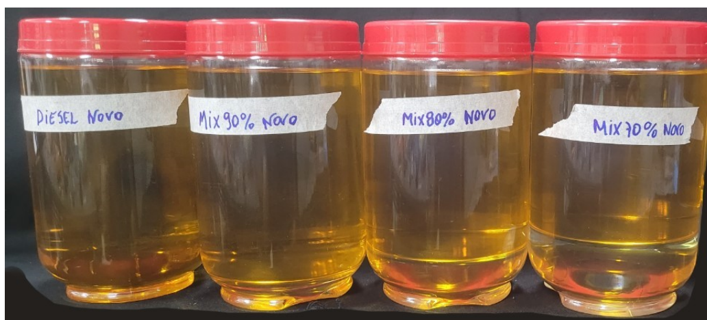
Figura 3.28 Amostras de diesel, MIX90, MIX80 e MIX70 utilizadas nos testes de validação 2 e 3.
