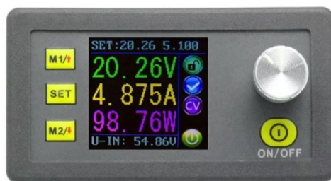
Figura 3.12 Fonte de alimentação fabricado pela Fancy Module, modelo Dp30v5a, usada para controlar e monitorar a corrente de polarização do LED ultravioleta.
