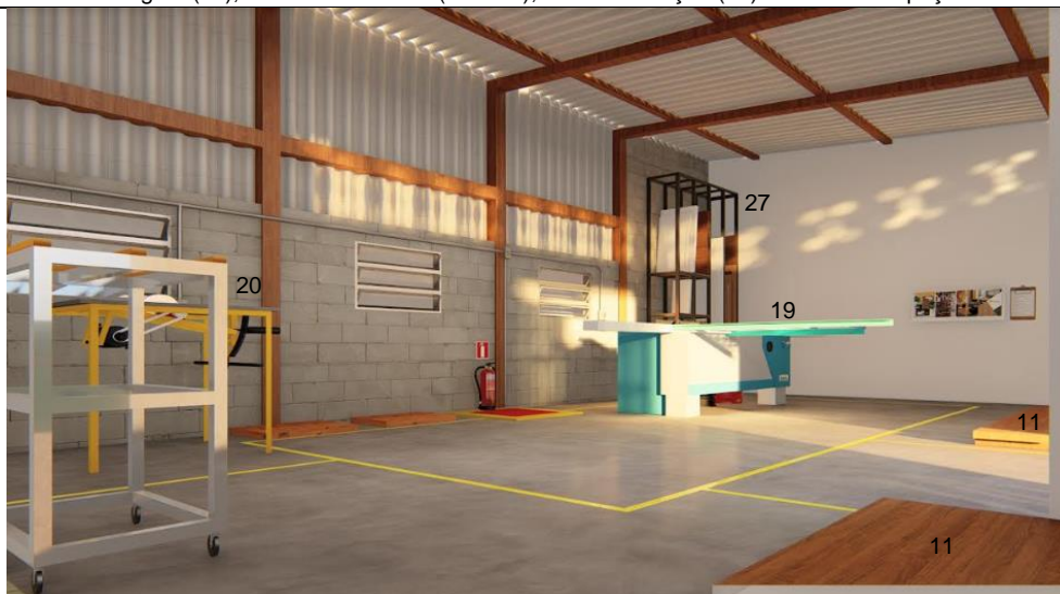
97i: setor de corte (19), setor de lixamento (20), estoque de MDF (11), estantes p/ subprodutos RRI (27), bancada/rodízio.
