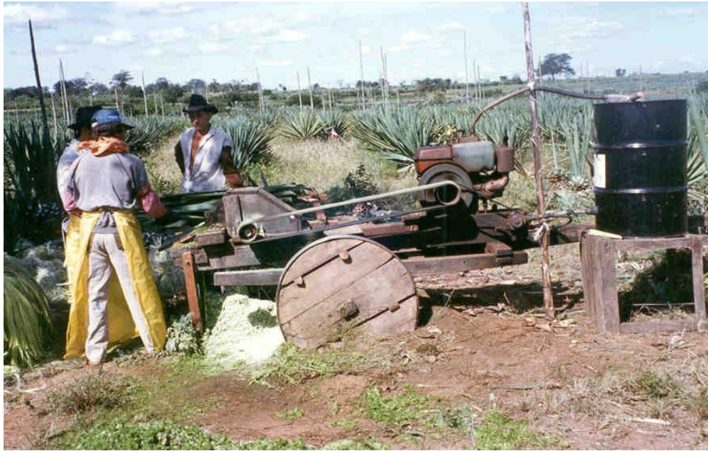
Figura 7 - Máquina desfibrando folhas de sisal
