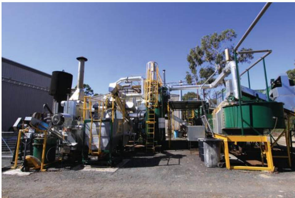
Figura 8 - Planta operada via pirólise lenta pela Pacific Pyrolysis PtyLtd em Somersby, Austrália.
