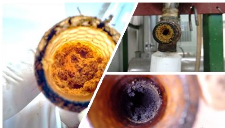
Figura 2 - Acúmulo de bio-óleo do resíduo do sisal em conexões e tubulações (testes prliminares)
