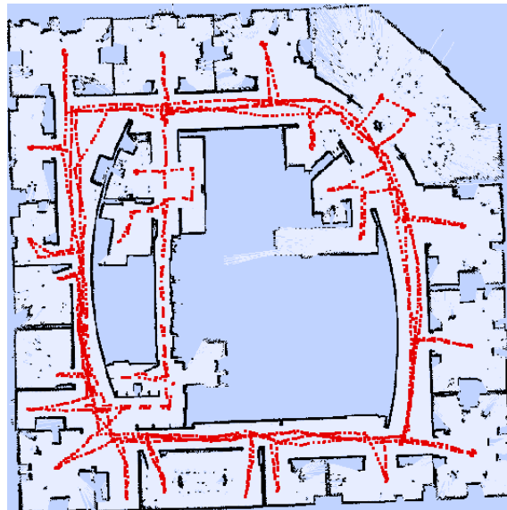
Figura 5.11: Pontos registrados (em vermelho) que foram visitados pelo robô no cenário Intel Lab. O percurso completo é de aproximadamente 2343 metros
