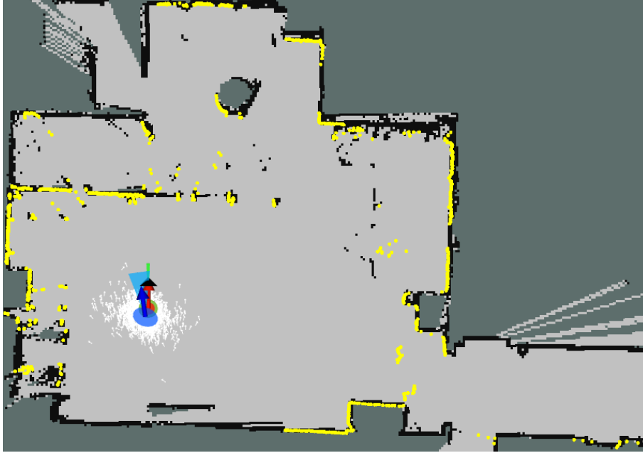
Figura 5.15: Incerteza sobre a pose no LaR: o robô se move pelo espaço livre e todos os métodos de localização rastreiam a pose correta. As setas em azul, vermelho e verde são as poses com covariâncias do AMCL, PM e PMcov, respectivamente. Pontos em amarelo representam amostras do sensor LiDAR
