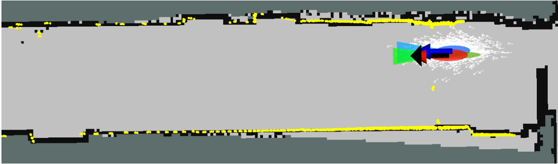
Figura 5.17: Incerteza sobre a pose no corredor: o robô está no início do corredor e se move em direção ao LaR enquanto todos os métodos de localização rastreiam a pose correta. As setas em azul, vermelho e verde são as poses com covariâncias do AMCL, PM e PMCOV, respectivamente. Pontos em amarelo representam amostras do sensor LiDAR
