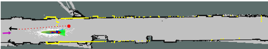
Figura 5.18: Incerteza sobre a pose no corredor: o robô está no meio do corredor e se move em direção ao LaR enquanto todos os métodos de localização rastreiam alguma pose incorreta na direção oposta ao Laboratório. As setas em azul, vermelho e verde são as poses com covariâncias do AMCL, PM e PMCOV, respectivamente. A seta em rosa indica uma pose erroneamente inicializada, enquanto o traçado em vermelho representa o percurso correto desde a inicialização. Pontos em amarelo representam amostras do sensor LiDAR
