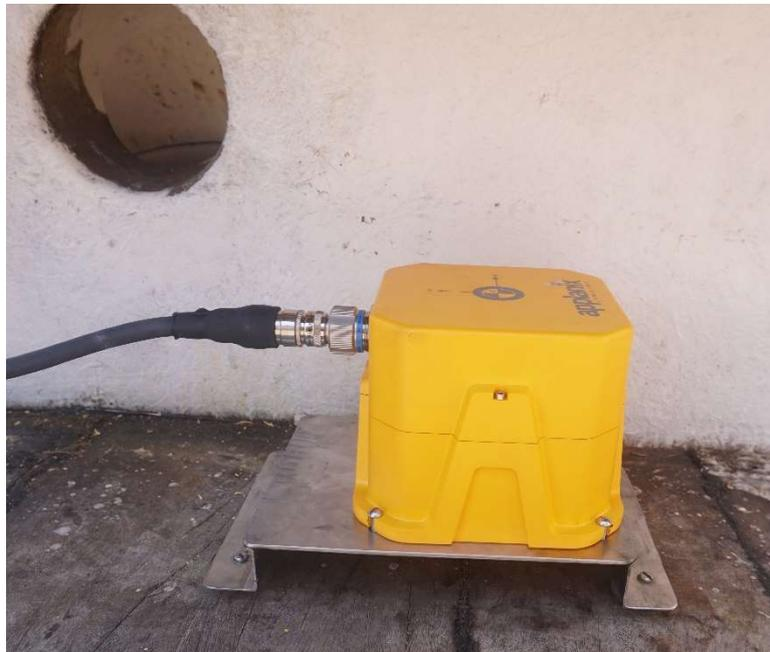
**Figura 4 - Sensor de movimento Applanix instalado na proa, próximo à cabine.**
