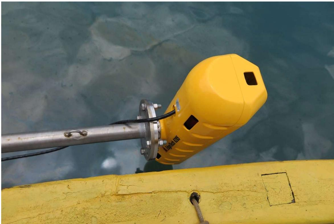
**Figura 2- Sonar fixado na haste na lateral da embarcação**
