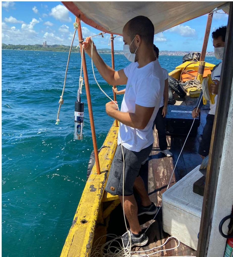
Figura 13 - Lançamento do SVP para medição da velocidade do som na coluna d'água.
