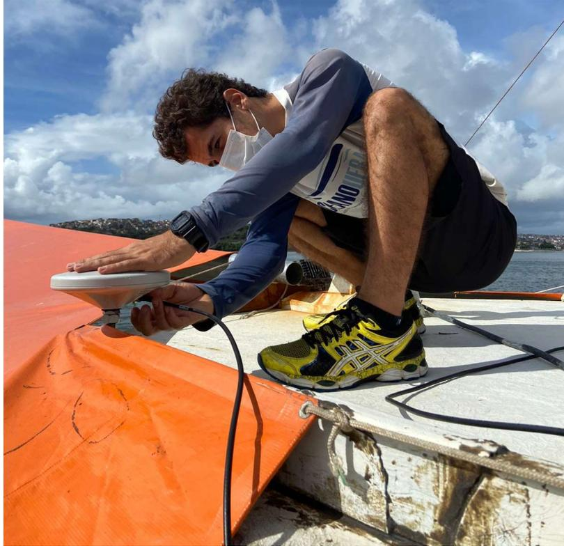
**Figura 3 - Antena GPS sendo instalada acima da cabine da embarcação**
