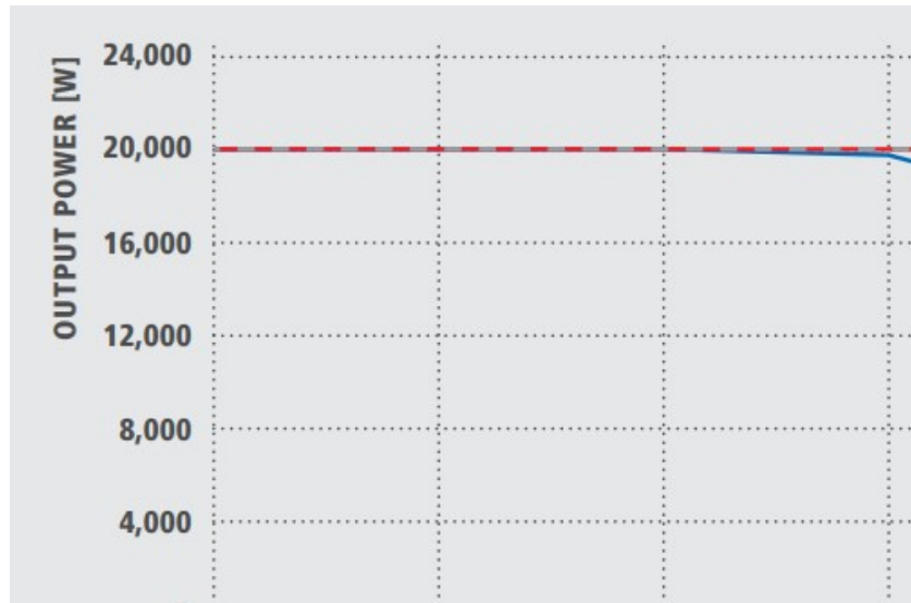
Figura 15: Potência de saída do inversor de frequência Fronius de 20.000W
