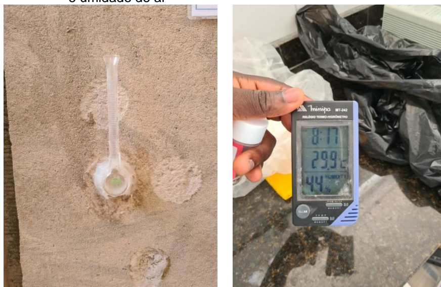
Figura 32- Fixação do cachimbo de vidro com a medição de temperatura e umidade do ar
