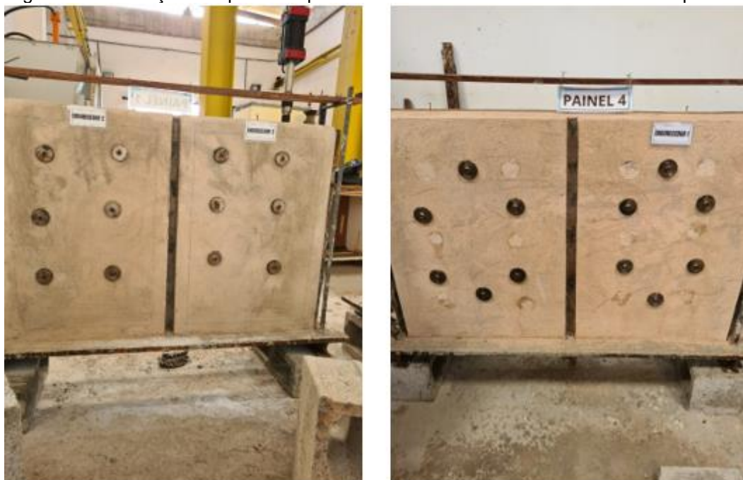
Figura 29- Colocação das pastilhas para o ensaio de resistência de aderência superficial
