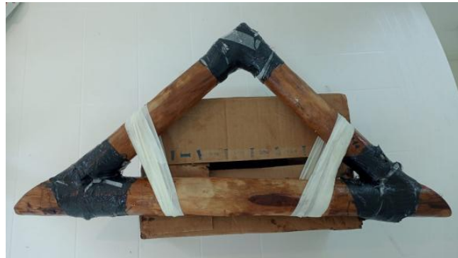
Figura 12 – Auxílio da fita crepe para a estabilidade do protótipo M1 durante a colagem dos nós inferiores
