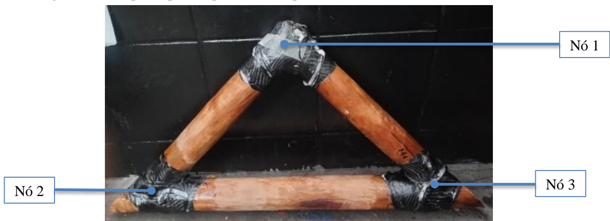
Figura 15 - Corpo de prova após ensaio experimental.
