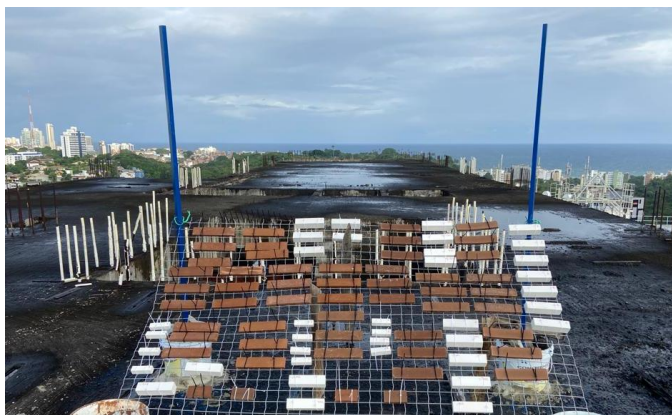
Figura 5.3 – Amostras posicionadas em suporte e expostas em ambiente natural.
