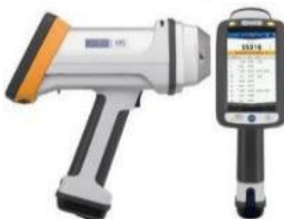
Figura 36. Analisador portátil Oxford Série X-MET7500.
