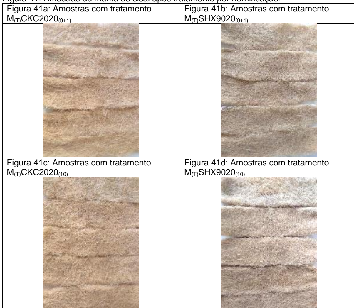
Figura 41. Amostras de manta de sisal após tratamento por hornificação.
