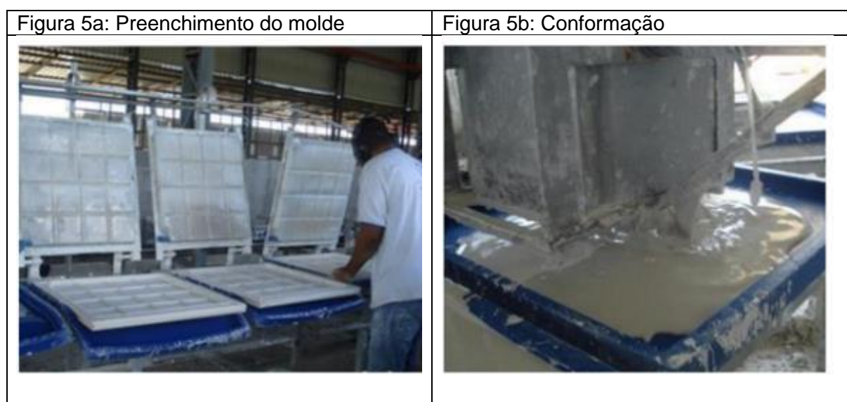
Figura 5. Produção chapa de gesso industrial em pequena indústria.
