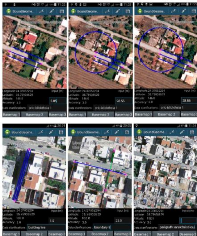
Figura 25 – Exemplos do uso do aplicativo BoundGeometry para digitalizar quinas de limites escondidos
