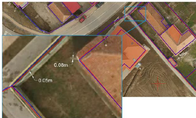
Figura 32 – Comparação dos limites coletados usando o procedimento proposto (em azul) com aqueles obtidos pelo Mapas Oficiais do cadastro
