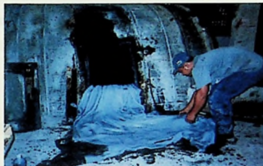
b– pele com o cromo para a curtição
