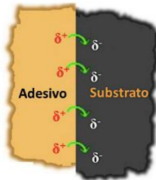
Figura 18: Teoria da adesão eletrostática, sendo \delta^+ e \delta^- cargas positivas e negativas, respectivamente.
