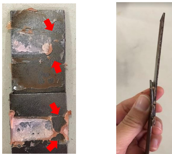
Figura 29: Degradação do adesivo, indicado pelas setas vermelhas, devido ao perfil de empenamento após preparação com Bristle Blaster ® nas juntas com adesivo acrílico.
