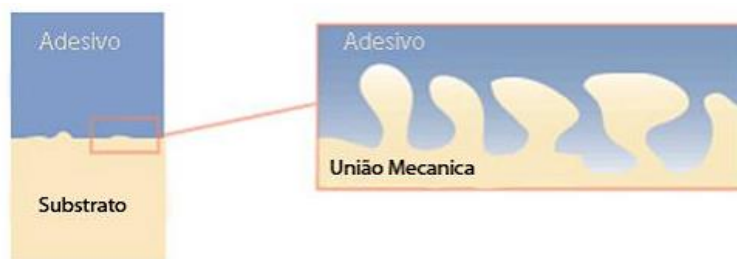
Figura 17: Teoria da adesão mecânica, exemplificada pela ancoragem mecânica (direita).
