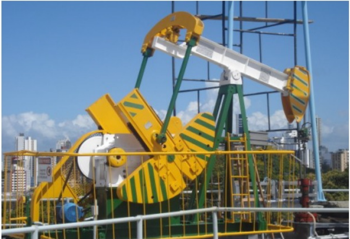
Figura 3.9: Unidade de Bombeio Instalada na Escola Politécnica da Universidade Federal da Bahia.
