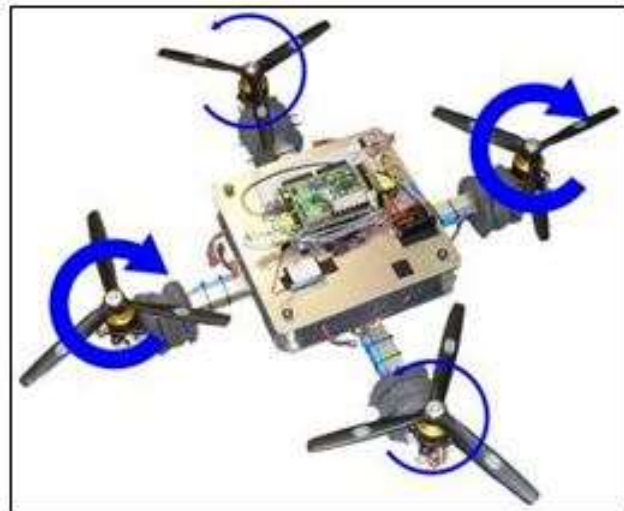
Figura 5: Impulso diferencial para dois pares de motores
