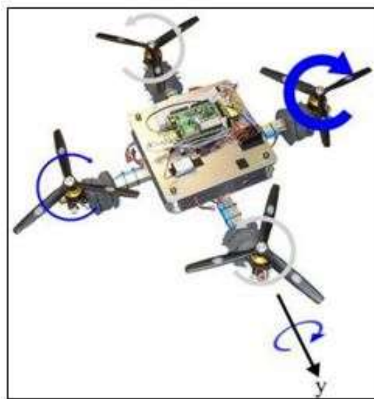
Figura 4: Impulso diferencial resultando em um momento em relação ao eixo Y
