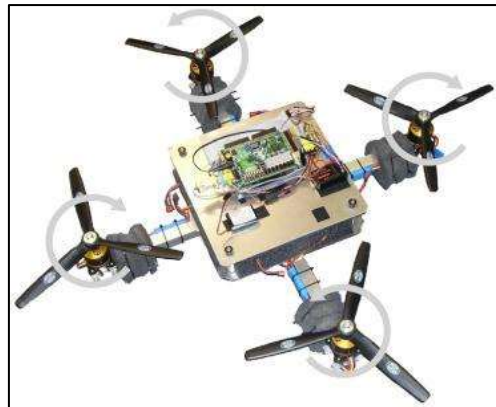
Figura 2: Sentido de rotação dos motores do VANT quadrotor, com equilíbrio dos torques
