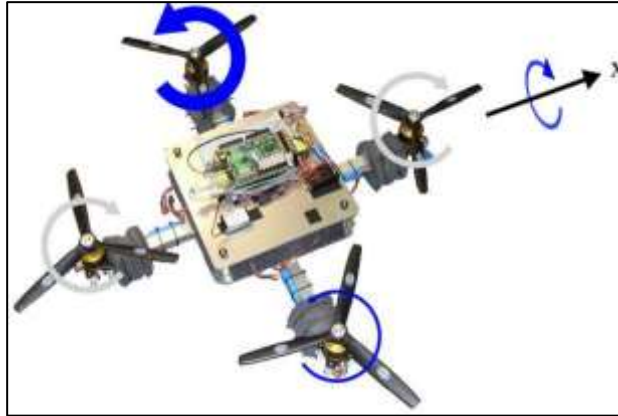
Figura 3: Impulso diferencial resultando em um momento em relação ao eixo X
