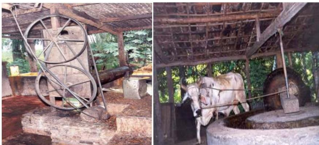
Figura 31: Roldões mecânico e de tração animal
