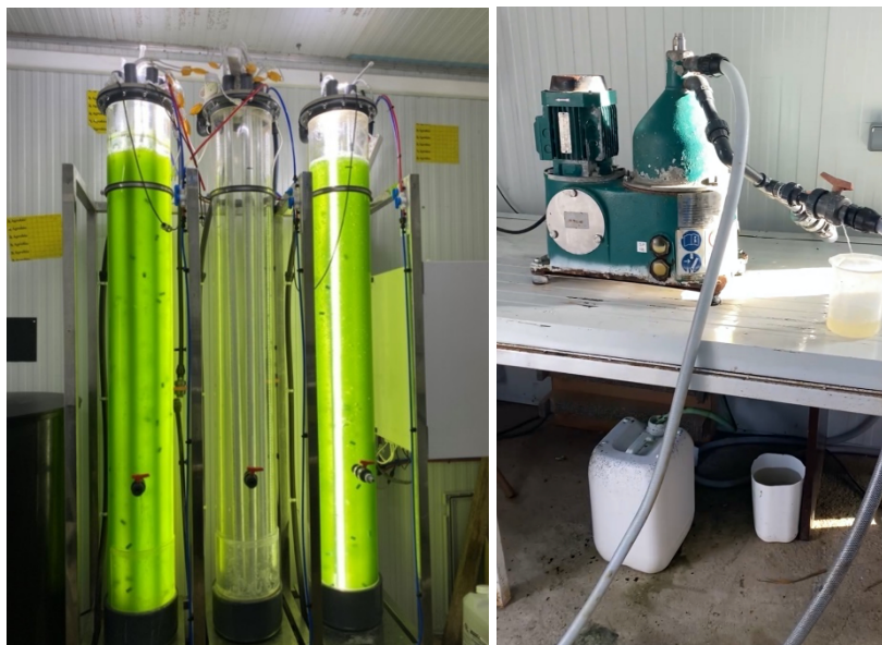
Figura 24 – Reatores de colunas de bolhas com controle automático para a produção de Chlorella vulgaris e a centrífuga semi-industrial
