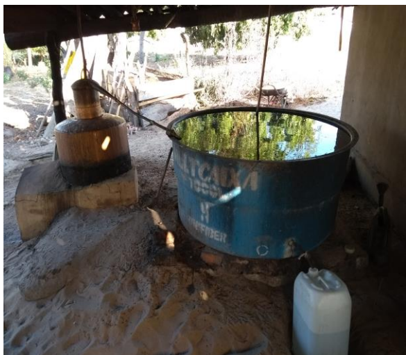
A) Caixa d'água usada para a condensação do álcool
