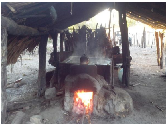
C) Fornalha alambique no Brejinho
