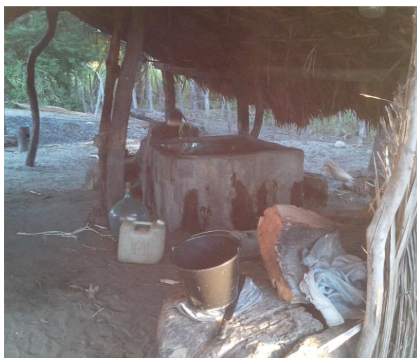
B) Tanque de cimento usado condensação do álcool
