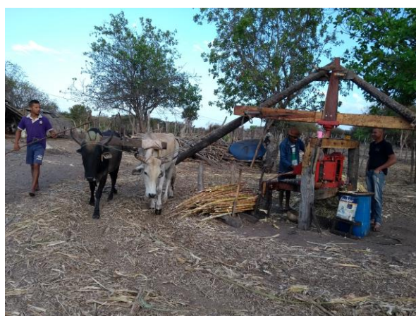
E) Engenho de ferro em funcionamento no Brejo dos Dois Riachos (BHRI)
