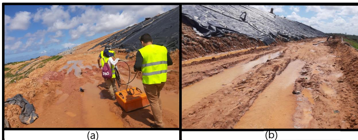
Figura 3.28: Imagem da aquisição de dados, onde é possível verificar (a) a situação superficial do solo (com água, úmido e saturado) do Perfil DD' e do (b) Perfil CC' antes da água.
