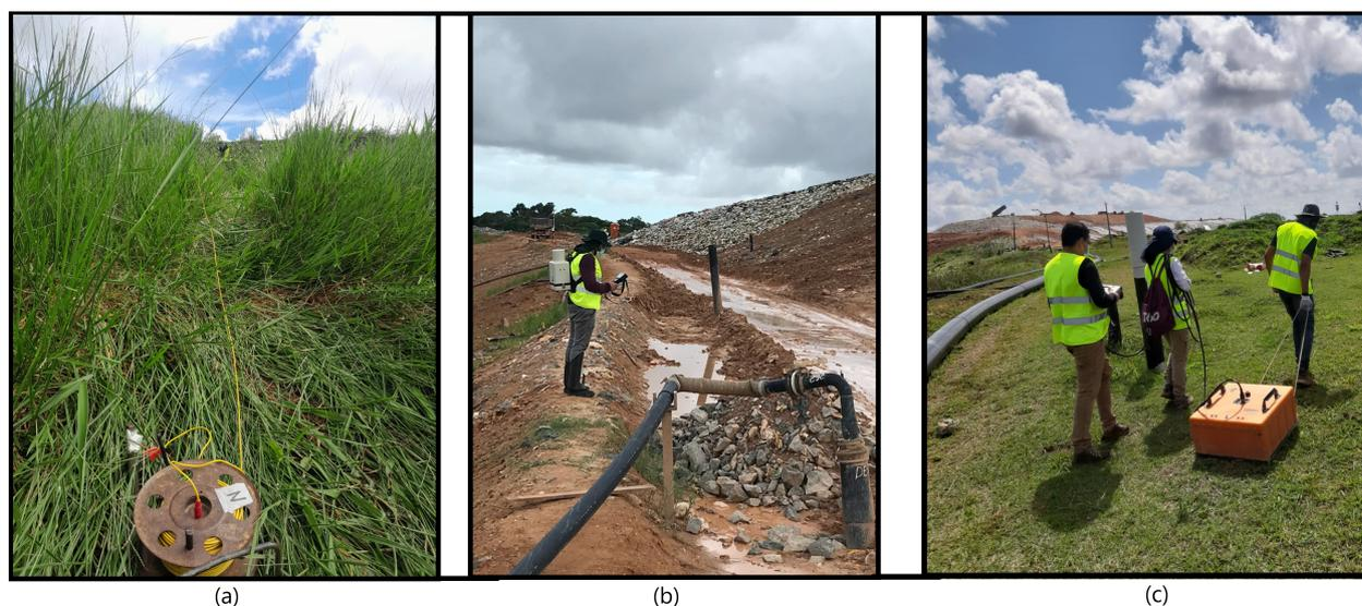
Figura 3.20: Imagens do levantamento de dados de (a) ER, (b) VLF e (c) GPR.
