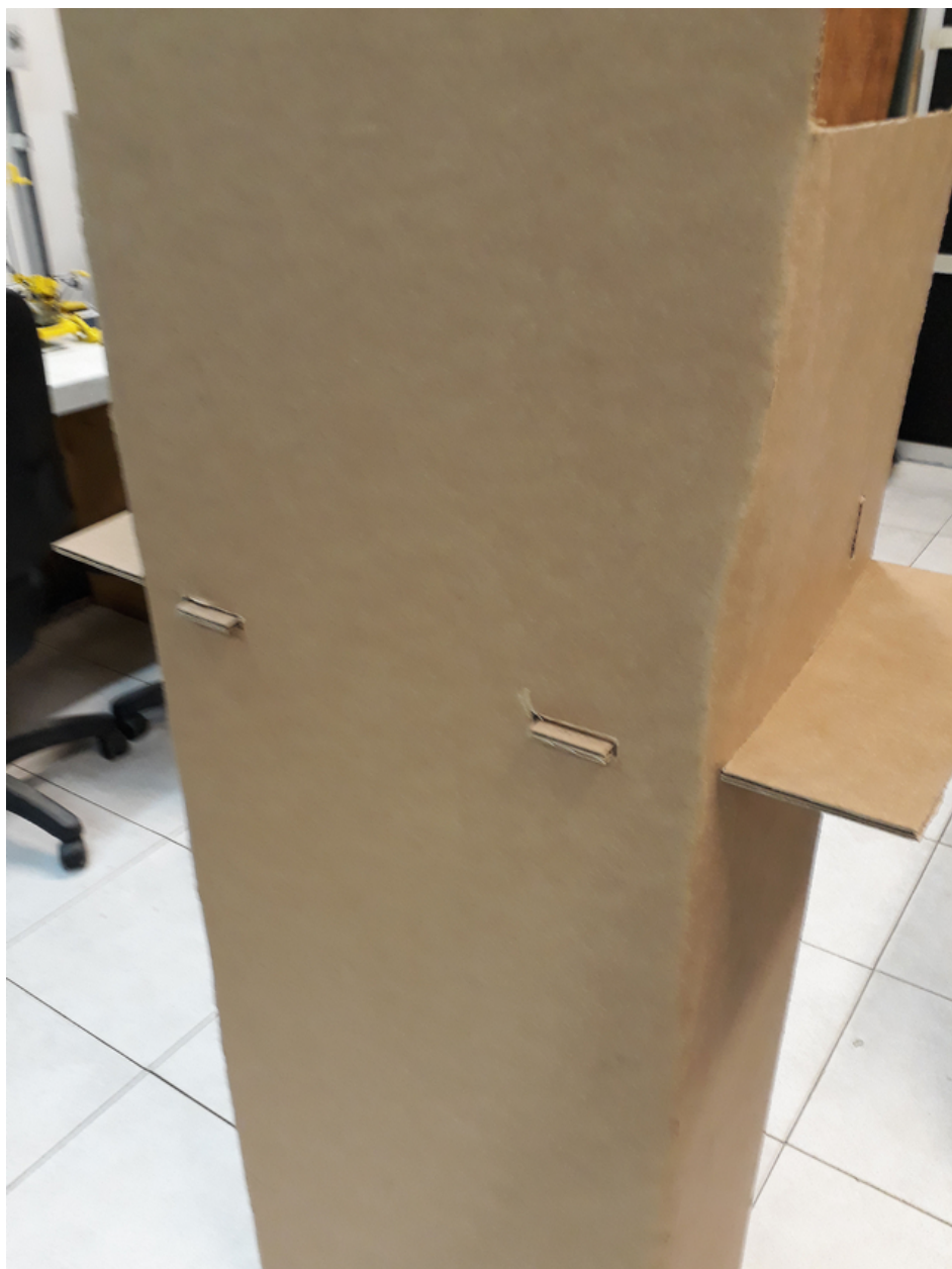
Figura 83 – Detalhe do encaixe da prateleira na parte posterior do expositor
