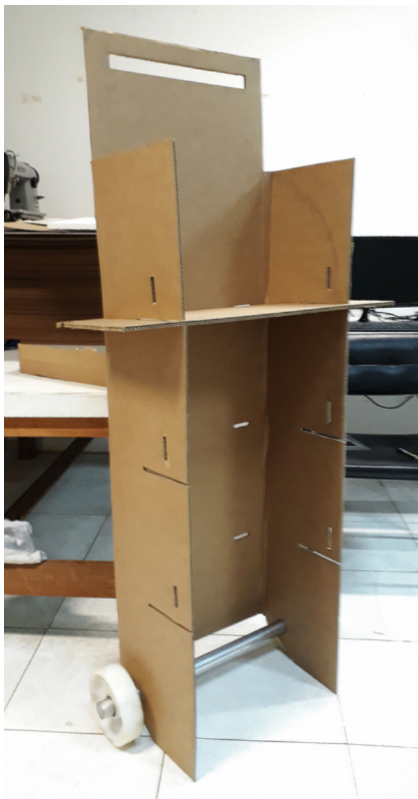
Figura 92 – Rodas e eixo previamente colocados
