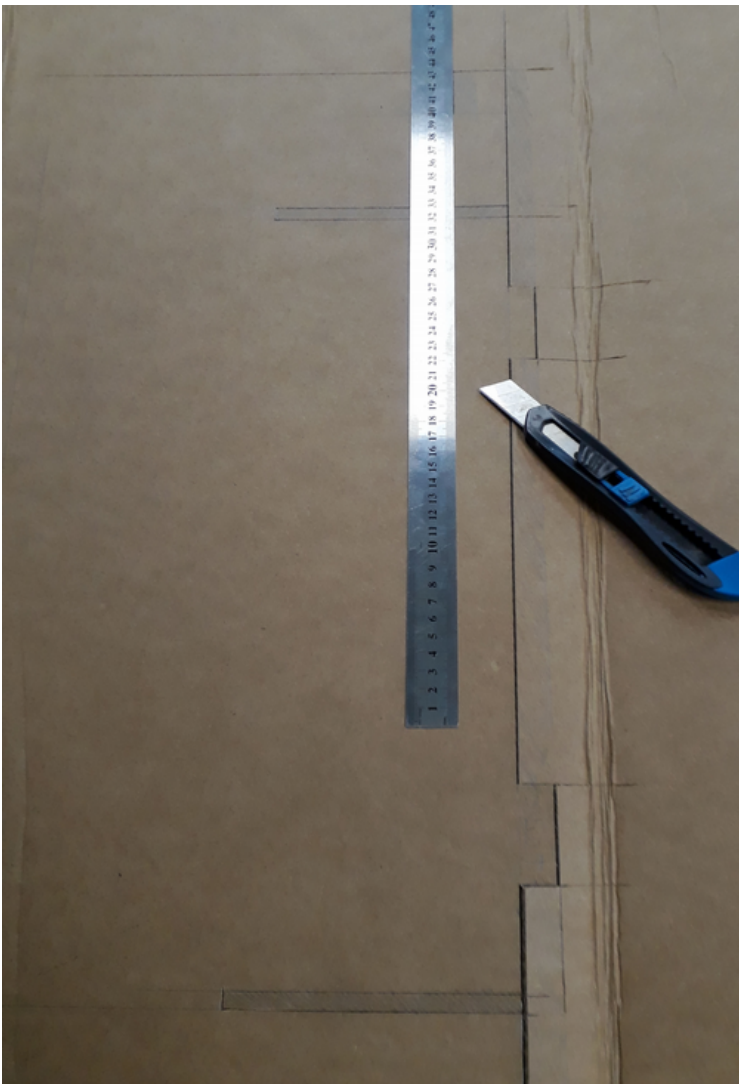
Figura 81 – Detalhe do corte com estilete em uma das prateleiras
