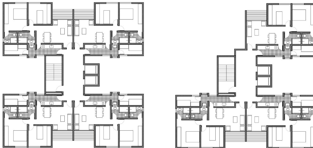
Figura 28 – Plantas indicativas do tipo H e da mais elementar supressão de uma das unidades do tipo como solução básica para o edifício com 3 unidades por andar.
