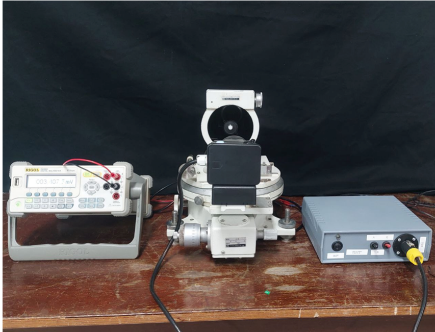
Figura 3.29 Aparato experimental utilizado para a determinação do ângulo de abertura do fly-eye e do piranômetro ALS20.
