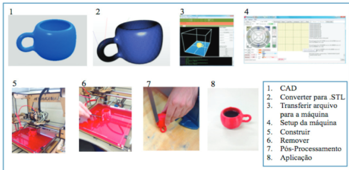
Figura 2.10 Principais etapas de produção de peças modeladas em 3D.
