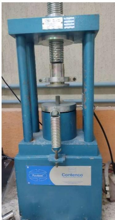
Figura 25: Prensa Universal Hidráulica Servo Controlada HD-20T, da Pavitest.
