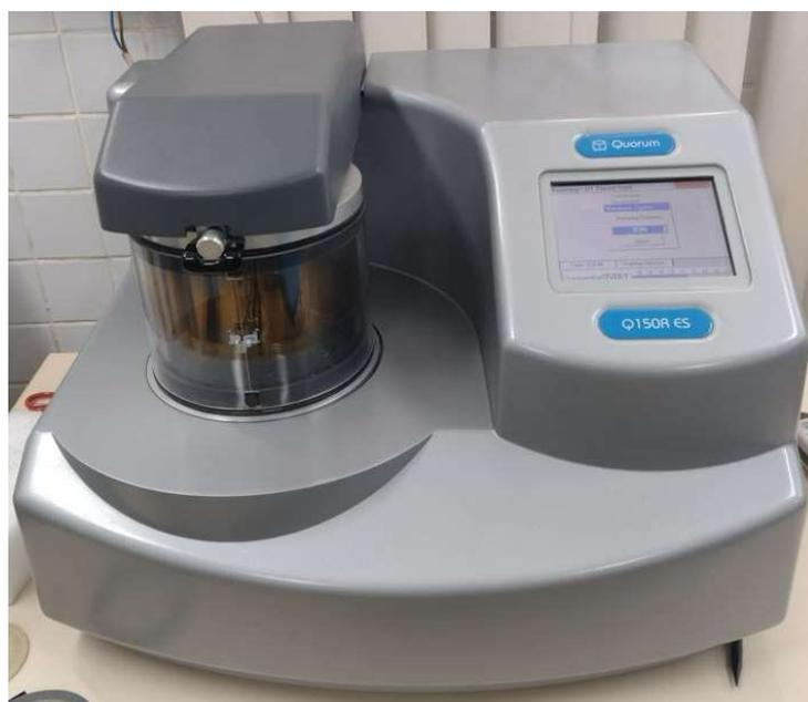
Figura 19: Metalizadora, modelo Q150R ES, fabricada pela Quorum
