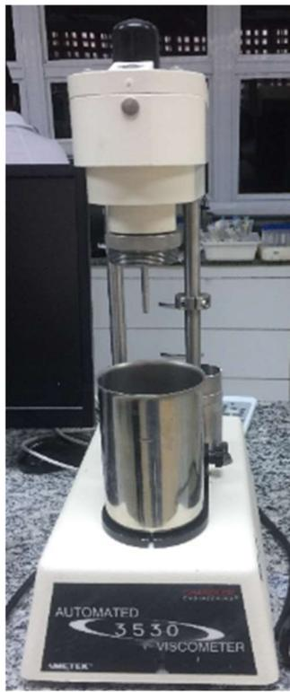
Figura 23: Viscosímetro de cilindros coaxiais da Chandler Engineering
