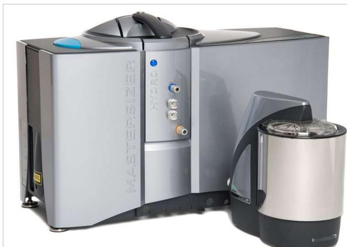
Figura 17: Analisador de tamanho de partícula, modelo Mastersizer 3000, Malvern Panalytical
