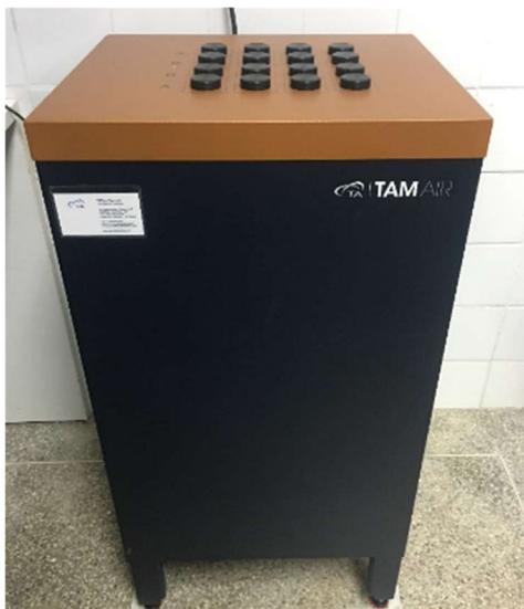
Figura 24: Calorímetro isotérmico TAM Air
