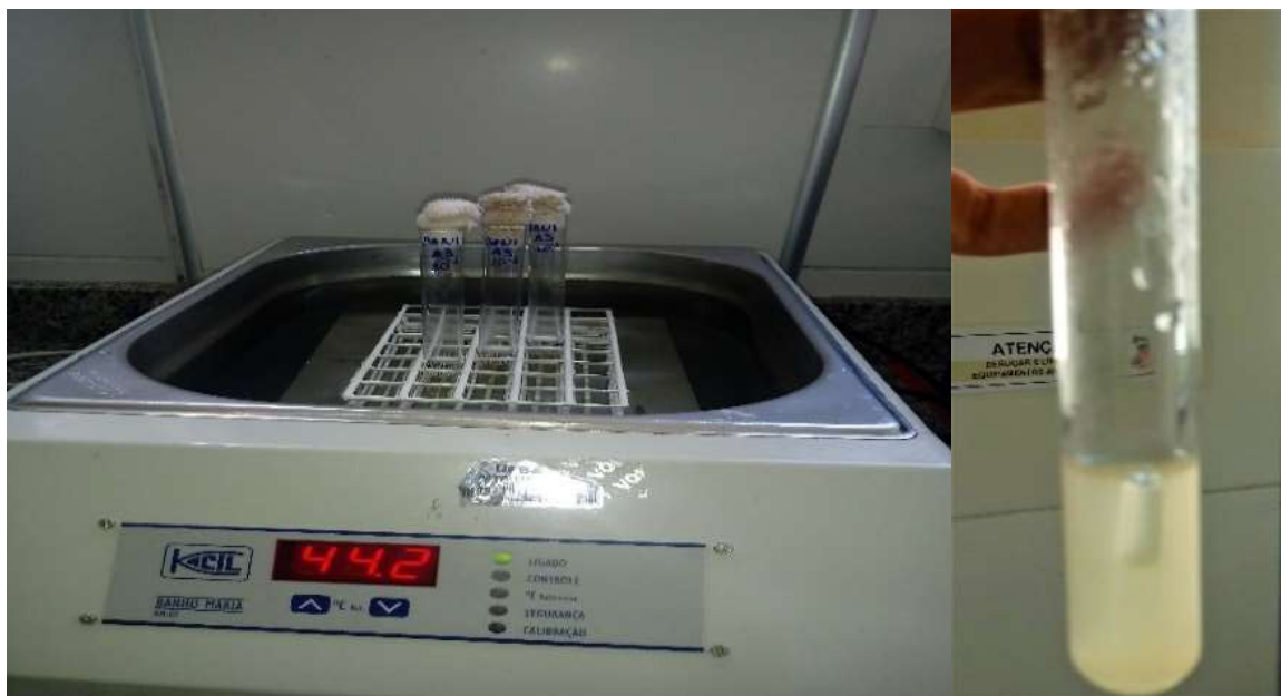
Figura 9- Imagem de tubos com caldo EC em banho-maria para crescimento de coliformes a 45°C e caldo EC positivo com formação de gás no interior do tubo de Durhan e turvação do meio.
