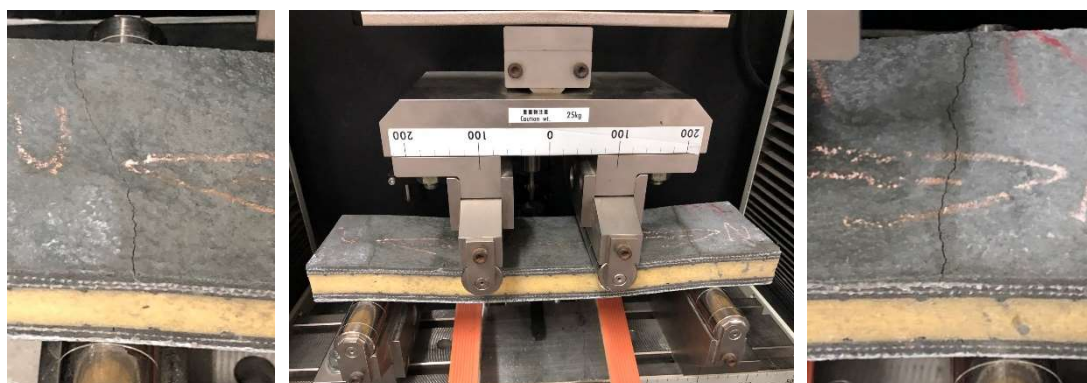
Figura 85. Fissuras na parte superior do Painel Sanduiche.
