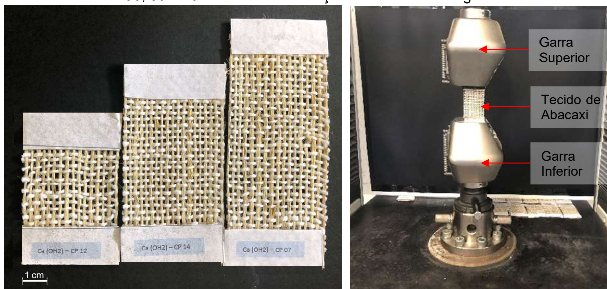
Figura 13. Corpos de prova com tecido de abacaxi, largura 40 mm, comprimentos ensaiados: 30, 50 e 70 mm. Ensaio de tração no tecido fibra vegetal.
