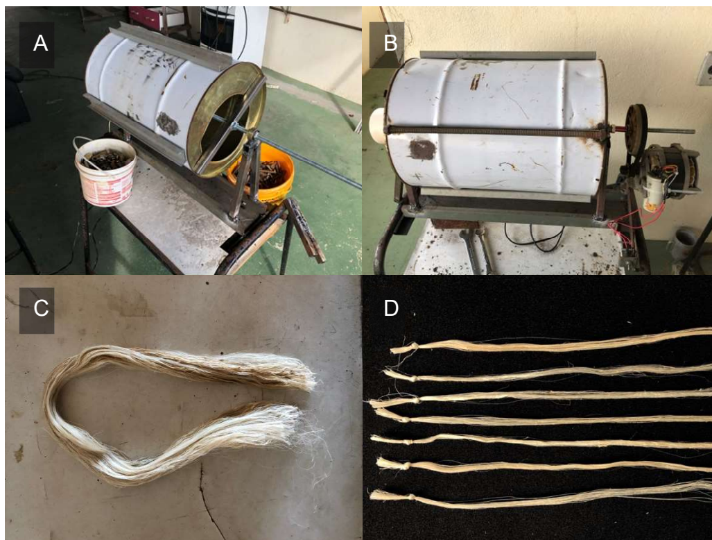
Figura 4 - A e B: "Batedeira"; C: Mecha após passar pela "batedeira"; D: Feixes de fibras.
