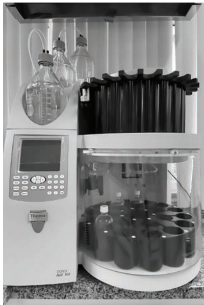
Figura 1 – Dionex ASE 350 (Thermo Scientific) utilizado para a extração com líquido pressurizado disponível no Lepetro/Igeo/UFBA
