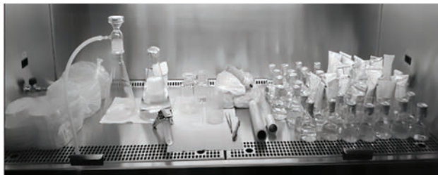
Figura 2 – Filtração a vácuo das amostras de água do mar para retenção dos microrganismos em membranas de celulose
