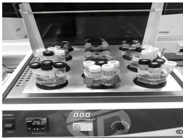
Figura 6 – Teste de oxidação com agitação (Teste 2) sobre mesa agitadora
