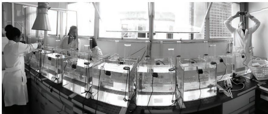
Figura 1 – Montagem do experimento de simulação artificial do derramamento de petróleo bruto em alto mar sob condições laboratoriais
