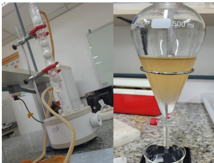
Figura 1 – À esquerda, processo de esterificação sob refluxo. À direita, extração da fase orgânica em balão de separação. Fonte: Grupo de pesquisa
