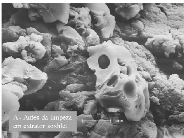
Figura 5. Microfotografia asfaltenos provenientes do arenito asfáltico ( Tar sand ). A- Depois da lavagem com n-hexano e antes da limpeza em extrator soxhlet . B – Depois da limpeza com n-hexano em extrator soxhlet . O aumento das microfotografias é de aproximadamente 1500x.
