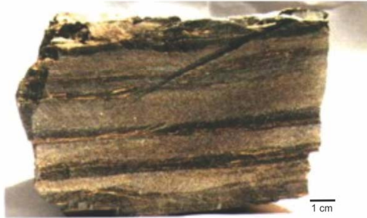
Foto 4.2.3 – Amostra de mão da rocha fosfática de Lagamar. Intercalações de níveis fosfáticos claros e escuros, ambos enriquecidos em P_2O_5 .
