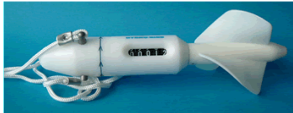
Figura 13 – Fluxômetro usado para a obtenção do volume de água filtrada. (Fonte: Catálogo Hydrobios).
