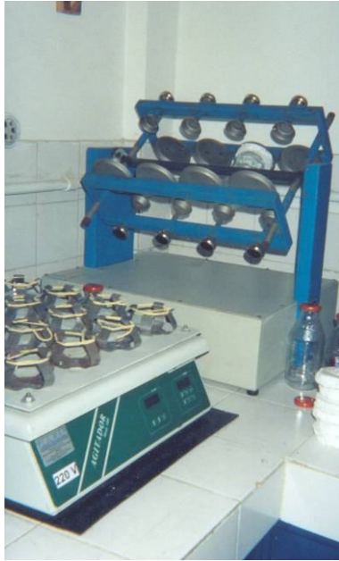
Figura 09: Homogeneizador das amostras, procedimento realizado antes da leitura. Laboratório de Sedimentologia da UFF (FOTO: Cláudia Cruz 2005).
