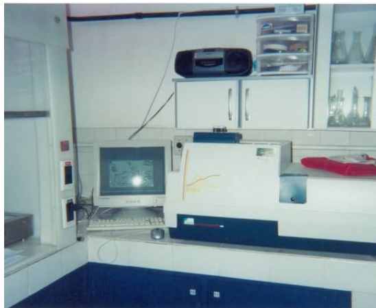
Figura 10: Aparelho utilizado para análise granulométrica. Laboratório de Sedimentologia da UFF (FOTO: Cláudia Cruz 2005).
