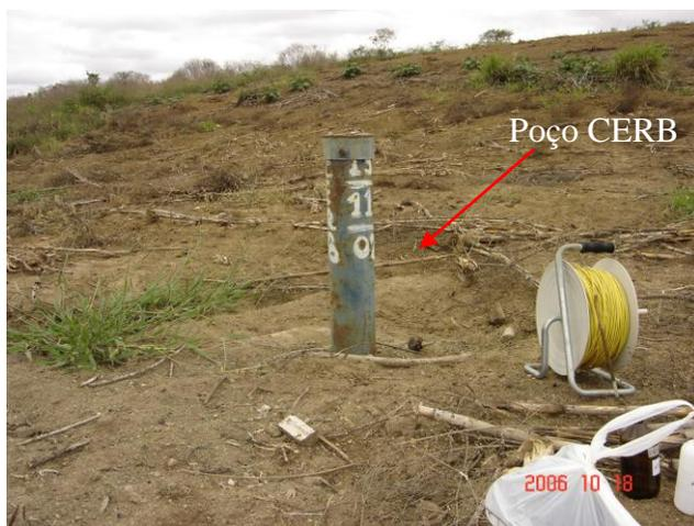
Foto 2.6- Tomada do nível estático de um poço não instalado usando medidor de nível sonoro.
