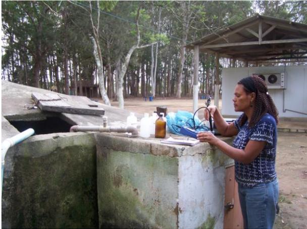
Foto 2.8- Mostrando o uso do WQC em sítio, analisando água de poço.
