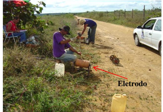
Foto 2.2- Eletrodos sendo fixados no solo para leitura da resistividade do material geológico em subsuperfície.
