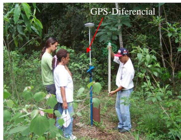
Foto 2.7- Mostrando o uso do GPS-Diferencial na determinação precisa da cota do terreno para definição do nível estáticos dos poços e coleta de água para análise química.
