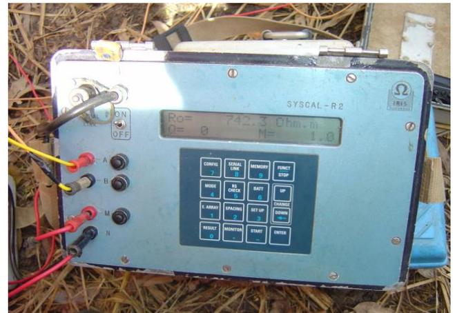
Foto 2.4- Mostrando o equipamento SYSCAL – usado para aquisição dos dados de campo.
