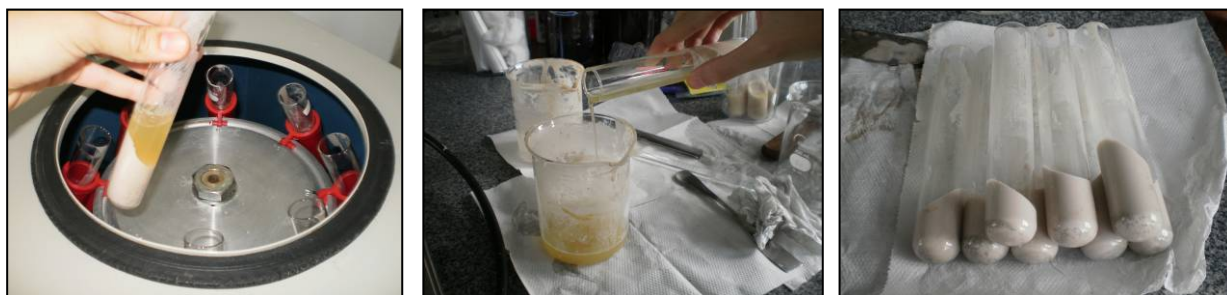
Figura 4: Tratamento de limpeza das amostras: processo de centrifugação, descarte do sobrenadante e obtenção da biomassa úmida.
