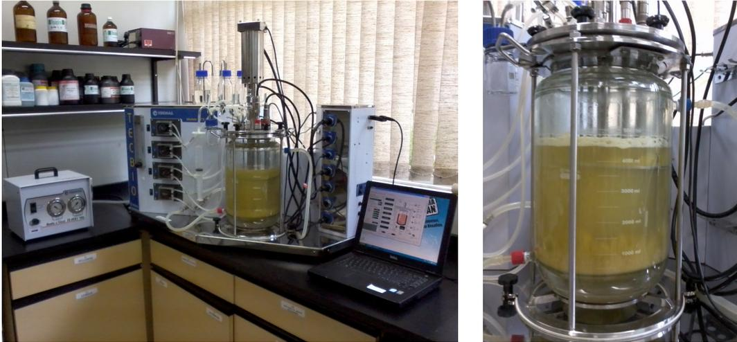
**Figura 1.** Fotos do biorreator durante o processo de fermentação do mosto de umbu.
