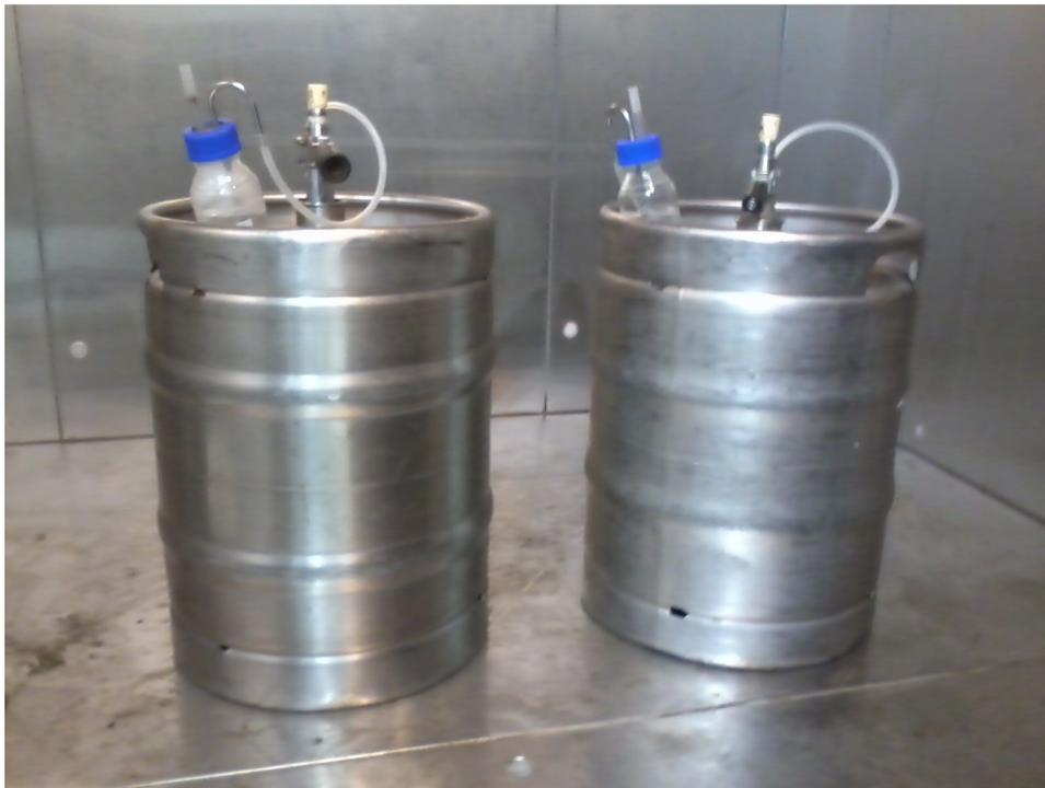
**Figura 2.** Fotos dos barris de aço inoxidável utilizados como fermentadores no processo de fermentação do mosto de umbu.
