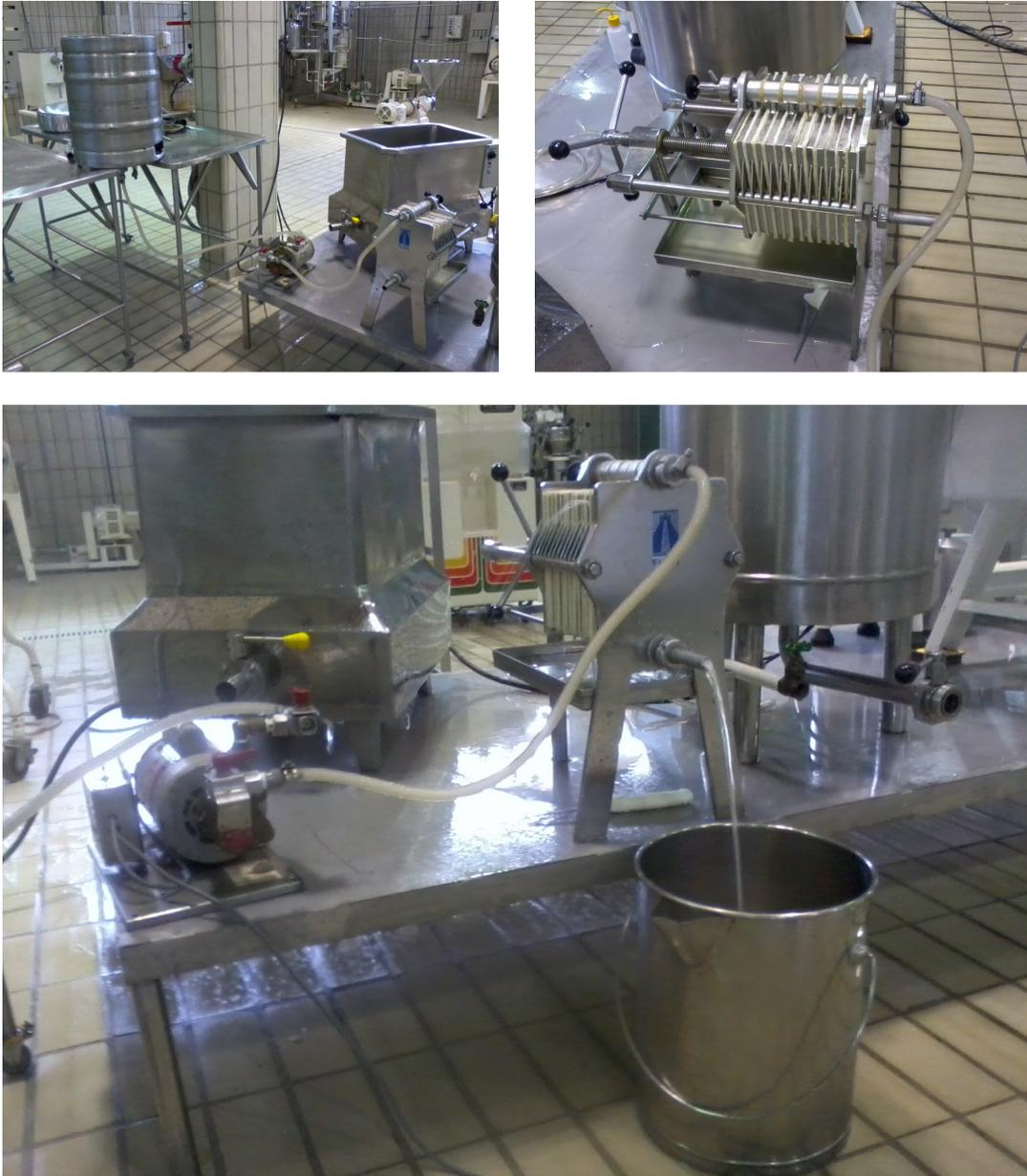
**Figura 3.** Fotos do processo de filtração convencional com filtro prensa.
