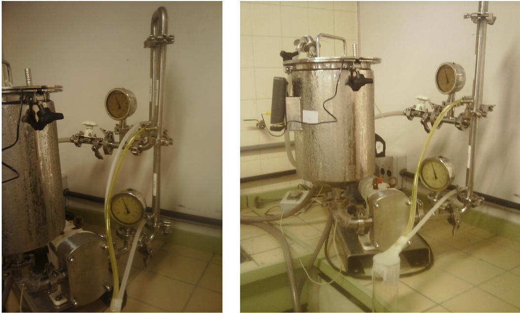
**Figura 4.** Fotos do processo de microfiltração em membrana cerâmica.
