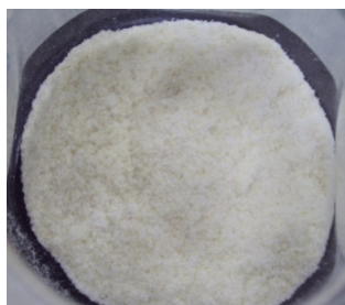
Figura 3. Polpa de celulose obtida após o processo de branqueamento com solução tampão (ácido acético e hipoclorito de sódio) e NaOH a 2%.
