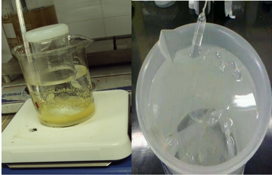
Figura 3. Etapas de (a) hidrólise ácida da celulose de coco para a obtenção da nanocelulose e (b) diálise da solução obtida após hidrólise, filtração e centrifugação, colocadas em membranas de celulose para obter a neutralidade da solução (pH 6-7).
