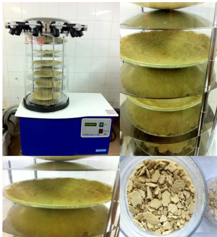
Figura 6 Liofilização do pólen da Melipona scutellaris L., Fonte: Acervo de fotografias do LABE/ Rodrigo
