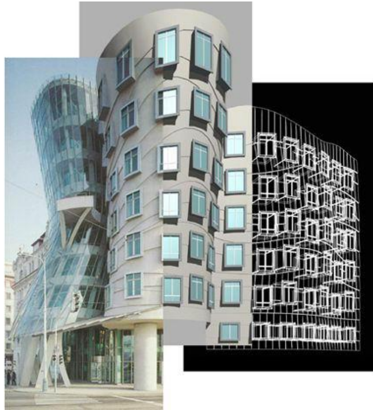
Figura 2.13: Fotomontagem composta pela imagem fotográfica do edifício (esquerda), o modelo da superfície com acabamento (centro) e sua forma geométrica desenvolvida em wireframe (direita). 29
