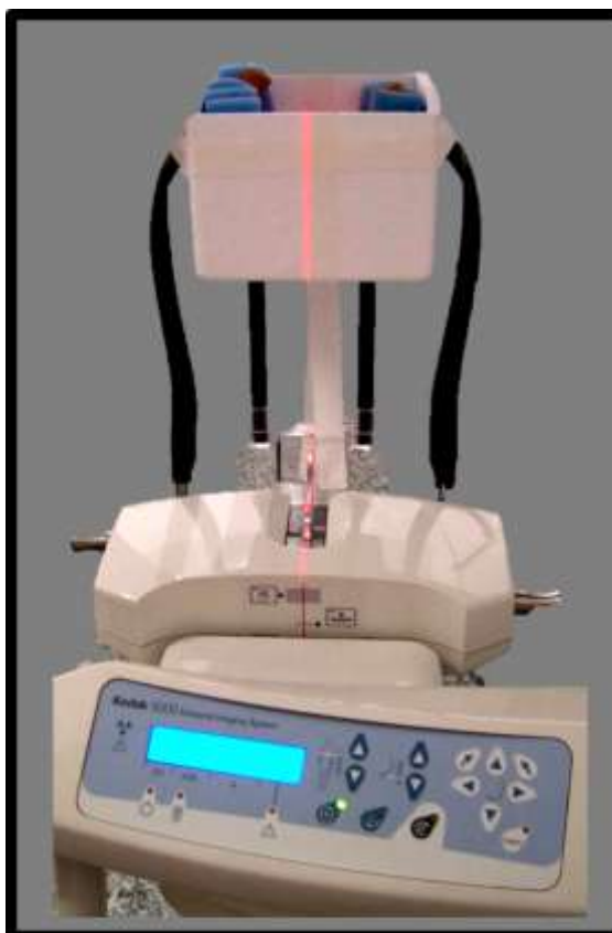
Figura 8 - Conjunto caixa de isopor/mandíbula posicionado no suporte do aparelho de TCFC K9000 3D, Kodak. Feixe de orientação luminoso indicando a linha média
