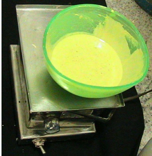
Figura 37 – Gesso vibrando por 10 segundos
