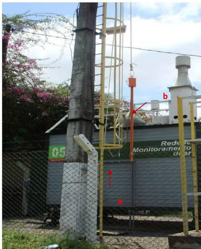
a – Tubo de difusão (denuder) para \text{NH}_3 / b – Sistema de termodifusão
