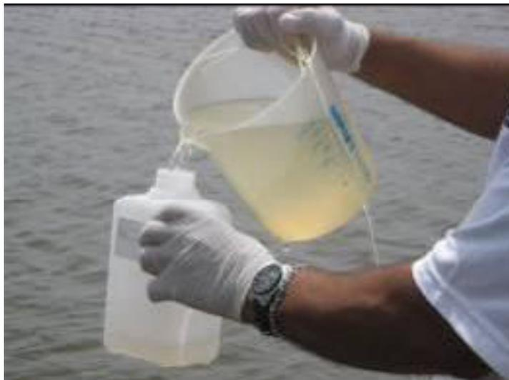
**Figura 8:** Transferência da amostra de água do amostrador para o recipiente de coleta. Fonte: INGÁ, 2008.
