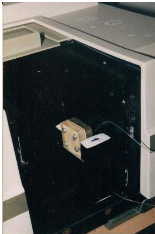
Fig. 47 – Cella de fluxo adaptada próximo ao detector do espectrofotômetro CARY-5E.
