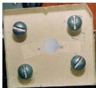
Fig. 53 – Lavagem e condicionamento da fase sólida modificada com solução transportadora (tampão acetato pH 4,8) para uma nova injeção da amostra.
