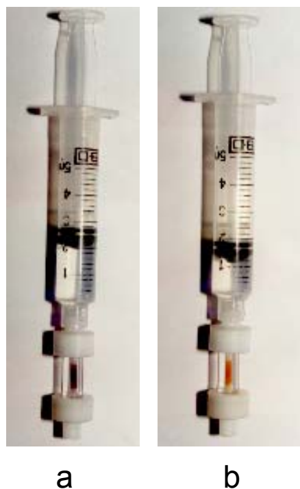
Fig. 29 – Imagens da cela axial adaptada a uma seringa: a) amostra sendo introduzida na cela; b) eluição do cobre com tiouréia.
