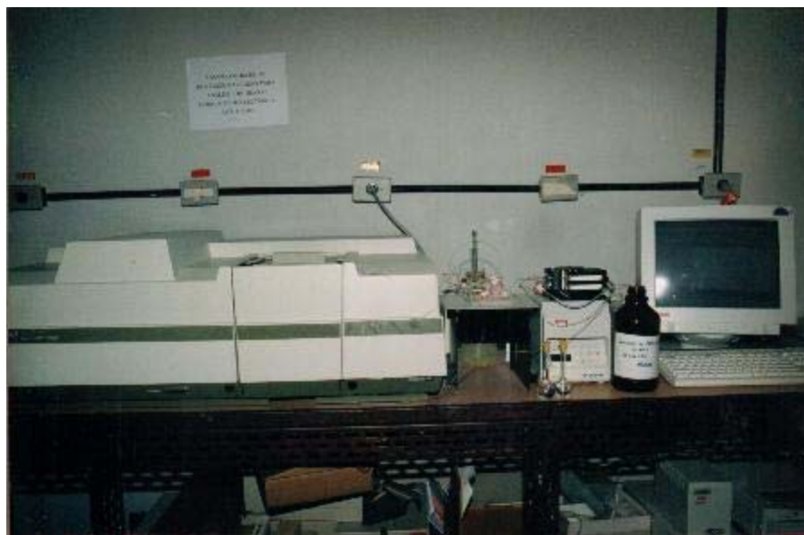
Fig. 46 – Sistema FI-EFS adaptado ao CARY – 5E
