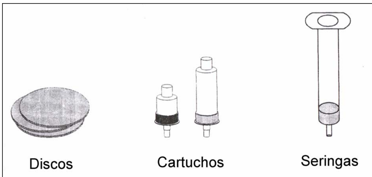
Fig.15 – Aparatos para EFS: discos, cartuchos e seringas.
