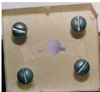
Fig. 50 – Injeção de 400 \mu L de Cu(I) 4,0 mg.L -1 , em presença de cloreto de hidroxilamina e tampão acetato pH 4,8.
