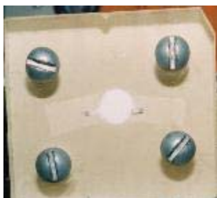
Fig. 48 – Sílica funcionalizada C18 modificada com cuproína. Fase sólida seca.
