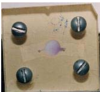
Fig. 52 – Eluição do Cu(I) 4,0 mg.L -1 com uma solução de Fe(III) 25mg.L -1 / HCl 5%.
