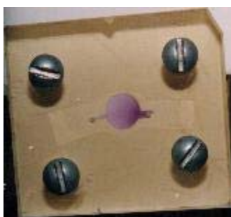
Fig. 51 – Retenção de 400 \mu L de Cu(I) 4,0 mg.L -1 , em presença de cloreto de hidroxilamina e tampão acetato pH 4,8.
