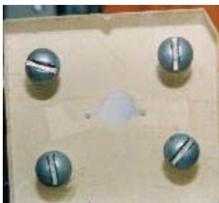
Fig. 49 – Fase sólida modificada sendo condicionada com solução transportadora (tampão acetato pH 4,8)
