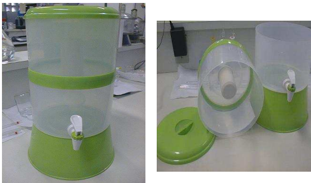
Figura 29 - Filtro de água, marca SAP FILTROS, capacidade 4L, usado para o dispositivo dessalinizador.
